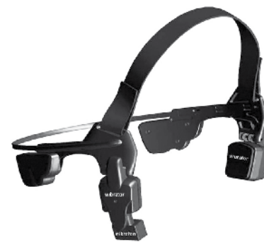
↑ Rys. 2. Wojskowa wersja systemu słuchawek kostnych wyposażonego w dwa wibratory i mikrofon kontaktowy
