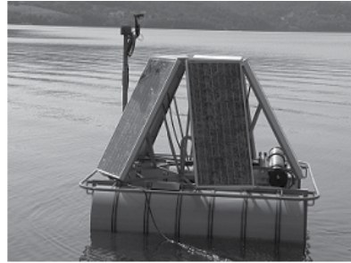
Rys. 2. Mobilna stacja pomiarowa w czasie pracy na jeziorze Dobczyckim.
