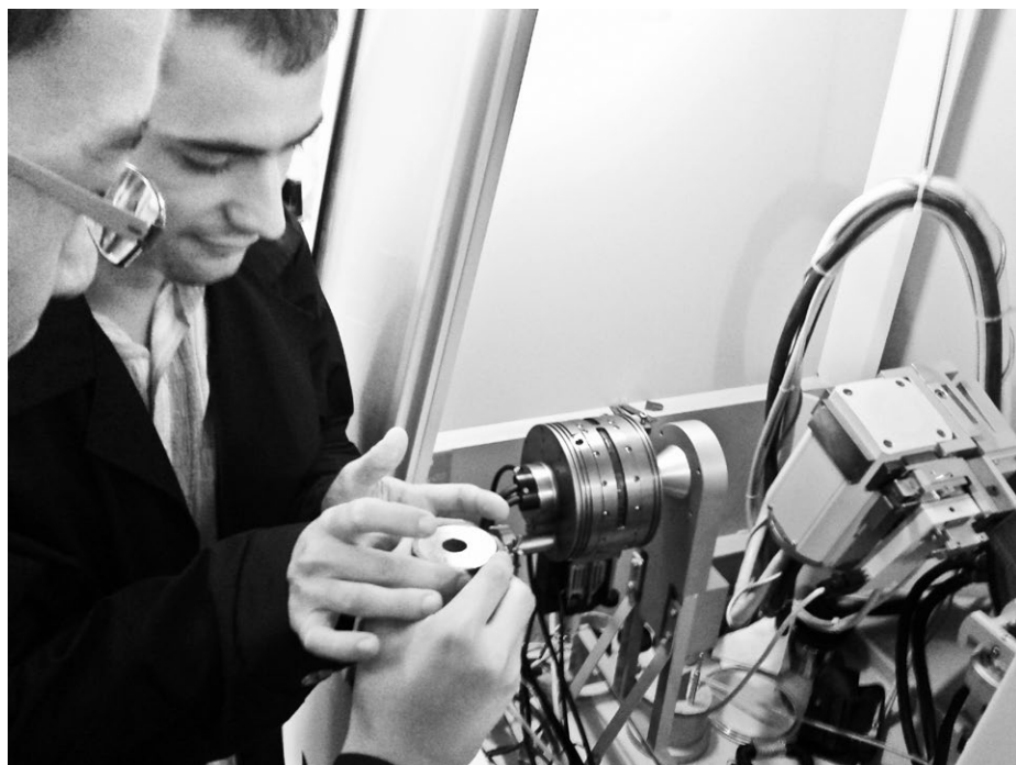
↑ Rys. 1. Przygotowanie materiału do badań metodą rentgenografii strukturalnej
