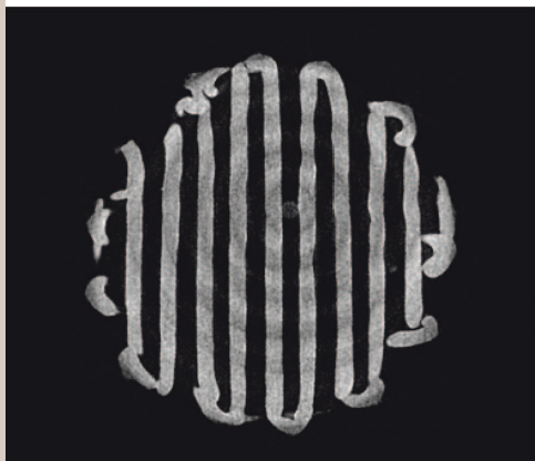
↑ Rusztowanie wykonane z polimeru biodegradowalnego za pomocą techniki szybkiego prototypowania. Zdjęcia zostały wykonane przy pomocy mikrotomografu rentgenowskiego, później obrazy te zostały poddane rekonstrukcji w trójwymiarowy model
