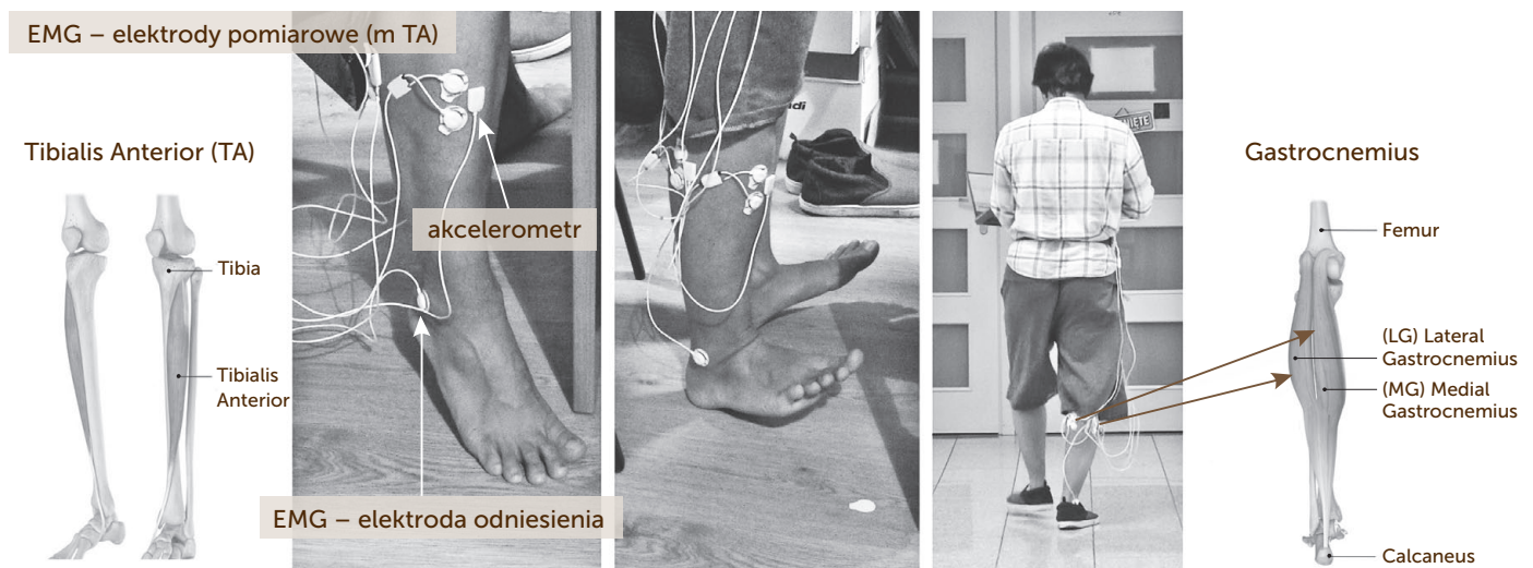
↑ Rys.3 Jednoczesny pomiar sygnałów EMG i MMG (mechanomiograficznych, obrazujących drgania mięśni: m. gastrocnemius , m. tibialis anterior ) na potrzeby jednej z prac doktorskich realizowanych na Wydziale MEiL
