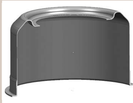
↑ Rys. 2 a) model komputerowy elementu, b) wyrób finalny uzyskany w procesie kształtowania obrotowego z nagrzewaniem laserowym
