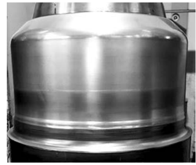
↑ Rys. 2 a) model komputerowy elementu, b) wyrób finalny uzyskany w procesie kształtowania obrotowego z nagrzewaniem laserowym
